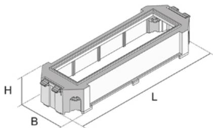
Черная пластиковая монтажная коробка, для установки в лючки. Состоит из цельного каркаса с фиксаторами кабеля и перфорированным дном. Предназначена для монтажа 3-х отдельных или 4-х совмещенных установочных модулей 45x45 мм с защёлками и 2-х штекерных соединений. Дно монтажной коробки опционально может быть закрыто глухой крышкой
