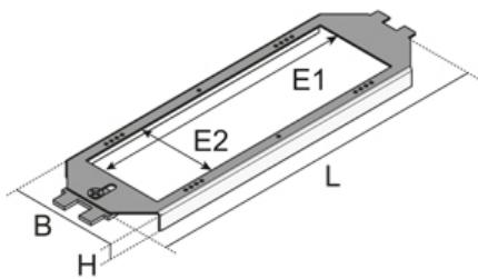
Несущая пластина из оцинкованной стали, для монтажа 3x АСО АМР пластин 60x70 мм.
