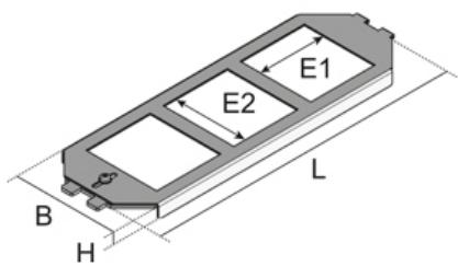
Несущая пластина из оцинкованной стали, для монтажа 3х подвесных модулей
