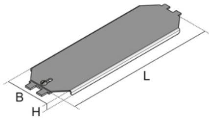
Несущая пластина, одинарная, глухая, из алюминия окрашенного в черный цвет Для закрытия монтажных отверстий в пластиковых элементах на месте.
