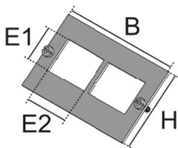
Монтажная пластина из алюминия с черным покрытием. Для установки в несущую пластину. Для размещения информационных разъемов
