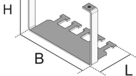
Фиксатор для кабеля из оцинкованной стали для разведения проводов информационных розеток.
