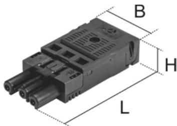
3-полюсный разъём с пружинной фиксацией кабеля сечением от 1,5 до 2,5 мм<sup>2</sup>, 250 V / 4kV / 20 A.
