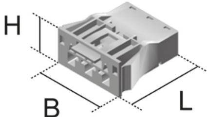
3-полюсный встраиваемый блок с защелками и фиксацией кабеля сечением от 0,5 до 4 мм<sup>2</sup>, 250 V/ 4kV / 25 A.
