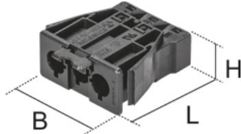
3-полюсный встраиваемый блок WIELAND с защелками и фиксацией кабеля сечением от 0,5 до 2,5 мм<sup>2</sup>, 250 V/ 4kV / 20 A.
