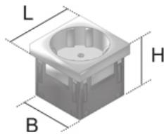
Пластиковый фиксирующийся модуль с одной силовой розеткой кремового цвета, размер 45x45 мм, с поворотом вилки на 33 или 0 град., штекерными зажимами, защитой от детей и номинальным напряжением/током: AC 250 V, 10/ 16A. Устанавливается в монтажной коробке
