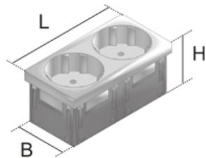
Пластиковый фиксирующийся модуль на 2 силовые розетки кремового цвета, размер 45x45 мм, с поворотом вилки на 33 град., штекерными зажимами, защитой от детей и номинальным напряжением/током: AC 250 V, 10/ 16A. Устанавливается в монтажной коробке
