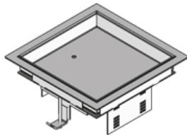
Четырёхугольный лючок из нержавеющей стали с напольной рамкой. Предназначен для встраивания в напольные коробки, монтажные крышки и отверстия в полу, для помещений с напольными покрытиями толщиной до 8 мм с сухой уборкой. Рассчитан на средние нагрузки.
