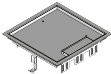
Напольный лючок четырёхугольный из нержавеющей стали Состоит из напольной рамы, для установки 3х монтажных коробок для 12 модулей 45x45 (или 9 подвесных модулей), крышки с выводом для кабеля, резинового уплотнителя и набора для крепежа Для установки в напольные коробки, монтажные крышки и двойные или пустотные полы Подходит для помещений с покрытием для сухой уборки или химчистки. Предназначен для офисных нагрузок.
