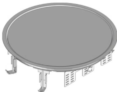
Круглый лючок с рамкой для напольного покрытия из нержавеющей стали. Плоская поверхность R9, подверглась пескоструйной обработке. Состоит из рамы с глухой крышкой, резинового уплотнителя и набора для крепежа. Для установки в напольные коробки, монтажные крышки и двойные или пустотные полы. Подходит для помещений с покрытием для сухой уборки или химчистки. Предназначен для офисных нагрузок.
