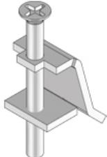
Для лючков, в случае установки в стяжку, двойной или пустотный пол Захват с диапазоном зажима 40-80 мм
