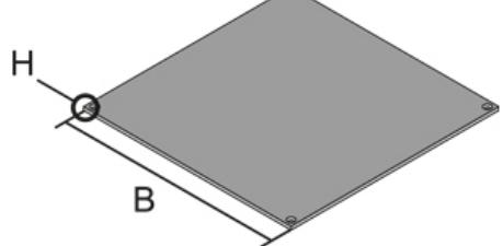
Четырёхугольная стальная пластина для закрывания нивелируемого каркаса. Для полов с сухой и влажной уборкой. Для средних нагрузок.
