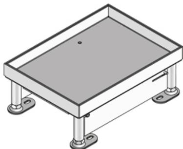
Напольный лючок, четырёхугольный, из нержавеющей стали. Состоит из нивелирующей рамы с глухой крышкой и резинового уплотнителя. Для установки в напольные коробки и двойные или пустотные полы. Подходит для помещений с покрытием для сухой уборки или химчистки. Предназначен для офисных нагрузок.
