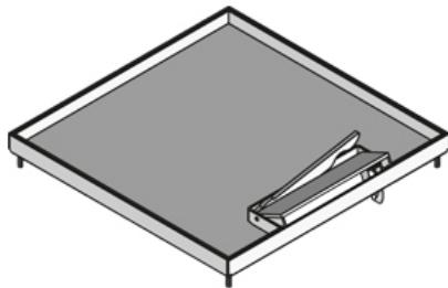
Напольный лючок, четырёхугольный, из нержавеющей стали. Лючок с выводом для кабеля и резиновым уплотнителем. Для монтажа на нивелируемый каркас и установки в напольные коробки и двойные или пустотные полы. Для размещения до 3 монтажных коробок, вмещающих до 9 подвесных модулей или 12 модулей 45x45 мм. Подходит для помещений с покрытием для сухой уборки или химчистки. Предназначен для офисных нагрузок.
