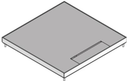
Четырёхугольный простой лючок из нержавеющей стали, прошедший пескоструйную обработку. Лючок с выводом для кабеля и резиновым уплотнителем. Для монтажа на нивелируемый каркас. Для размещения до 3 монтажных коробок, вмещающих до 9 подвесных модулей или 12 модулей 45x45 мм. Подходит для помещений с покрытием для сухой уборки или химчистки. Предназначен для офисных нагрузок.
