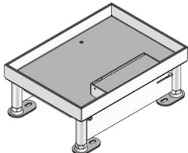
Напольный лючок, четырехугольный, из нержавеющей стали. Состоит из нивелирующей рамы с крышкой с выводом для кабеля и резинового уплотнителя. Для установки в напольные коробки и двойные или пустотные полы. Для размещения до 2 монтажных коробок, вмещающих до 6 подвесных модулей или 8 модулей 45x45 мм. Подходит для помещений с покрытием для сухой уборки или химчистки. Предназначен для офисных нагрузок.
