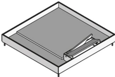
Напольный лючок, четырёхугольный, из нержавеющей стали. Состоит из рамы с крышкой для вывода кабеля, стальной вставки, резинового уплотнителя и набора для крепежа. Для установки в напольные коробки, монтажные крышки и двойные или пустотные полы. Для размещения до 3 монтажных коробок, вмещающих до 9 подвесных модулей или 12 модулей 45x45 мм. Подходит для помещений с покрытием для сухой уборки или химчистки. Рассчитан на высокие нагрузки.
