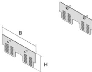
Набор каркасных держателей из оцинкованной стали. Содержит два держателя для двух монтажных коробок. Для четырёхугольных нивелируемых каркасов
