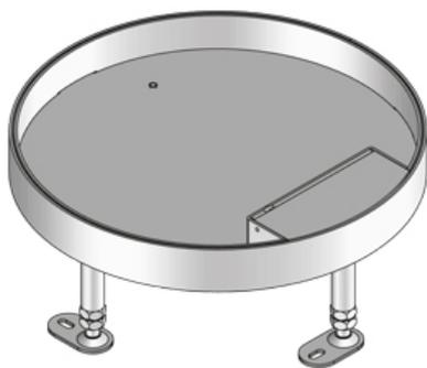
Напольный лючок круглый из нержавеющей стали Нивелируемый лючок с выводом для кабеля и резиновым уплотнителем, для установки в напольные коробки, монтажные крышки и двойные или пустотные полы Для размещения до 3 монтажных коробок, вмещающих до 9 подвесных модулей или 12 модулей 45x45 мм Подходит для помещений с покрытием для сухой уборки или химчистки. Предназначен для офисных нагрузок.
