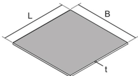
Вставка из пластика для нивелирования толщины напольного покрытия, для стального лючка
