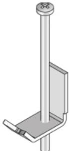
Для лючков, в случае установки в стяжку, двойной или пустотный пол Захват с диапазоном зажима 40-80 мм
