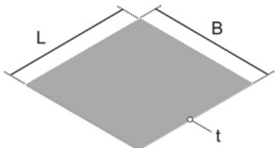
Вставка в четырехугольную глухую крышку, для нивелирования толщины напольного покрытия
