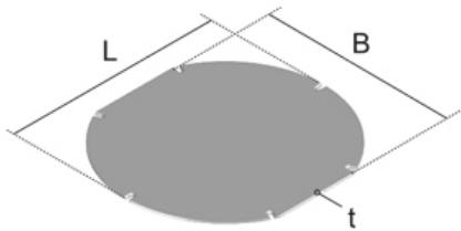
Картонная вкладка (3 мм) для круглой глухой пластмассовой крышки лючка. Для уменьшения провала напольного покрытия.
