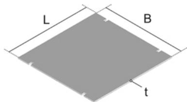
Картонная вкладка (3 мм) для четырёхугольной глухой пластмассовой крышки лючка. Для уменьшения провала напольного покрытия.
