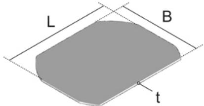
Картонная вкладка (3 мм) для круглой пластмассовой крышки лючка с выводом для кабеля. Для уменьшения провала напольного покрытия.
