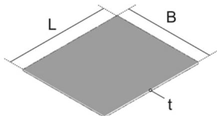
Картонная вкладка (3 мм) для четырёхугольной пластмассовой крышки лючка с выводом для кабеля. Для уменьшения провала напольного покрытия.
