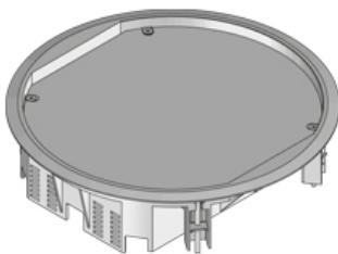
Напольный лючок, круглый, глухой, из пластика. Состоит из рамы и набора для крепежа. Для установки в напольные коробки, монтажные крышки и двойные или пустотные полы. Подходит для полов с сухой уборкой и покрытий до 8 мм. Предназначен для офисных нагрузок.
