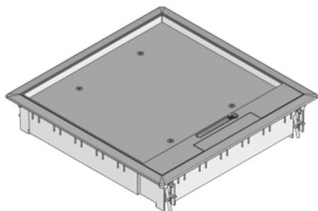
Напольный лючок, четырёхугольный, из пластика для трёх монтажных коробок (12 модулей 45x45 или 9 подвесных модулей), крышкой для вывода кабеля, направляющих для кабеля и набора для крепежа. Для установки в напольные коробки, монтажные крышки и двойные или пустотные полы Подходит для помещений с сухой уборкой с напольными покрытиями до 10мм Предназначен для офисных нагрузок.
