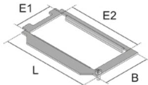
Монтажная пластина из листовой стали. Для установки в простой лючок. Подходит для установки 2 модулей 45x45 мм
