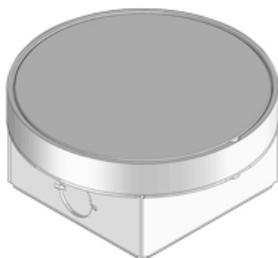
Круглый розеточный вывод для машинной чистки из листовой нержавеющей стали. Включая одинарную белую розетку с заземлением. Нивелируемый блок с тубусом, корпус из листовой стали. Для прямой установки в стяжку. Подходит для помещений с неглубокой структурой пола и влажной уборкой. Предназначен для офисных нагрузок.
