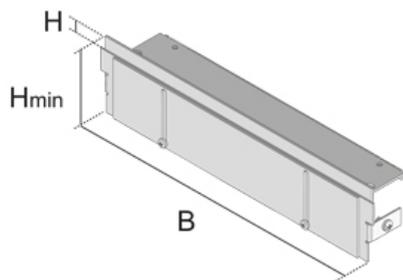
Заглушка с фланцем, может быть адаптирована к высоте напольного покрытия, для закрытия торца канала на уровне пола
