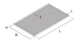
Крышка глухая, под напольное покрытие, из нержавеющей стали для установки в канале на уровне пола. Можно использовать взамен заглушки. Рассчитана на офисные нагрузки
