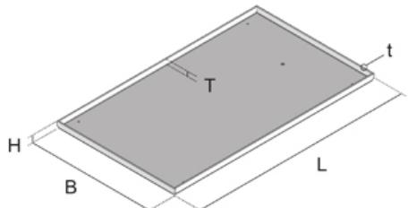
Крышка глухая, под напольное покрытие, из нержавеющей стали для установки в канале на уровне пола. Можно использовать взамен заглушки. Рассчитана на офисные нагрузки
