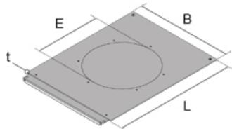
Монтажная крышка, круглая, из оцинкованной стали Может использоваться взамен глухой крышки для размещения двойного лючка Предназначен для офисных нагрузок.
