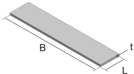
дистанционная пластина для закладки в собранный боковой профиль нижнего элемента канала на уровне пола для тяжёлых нагрузок перед заливкой бетоном (стяжкой).
