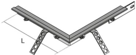
Внешний угловой профиль из стали горячего цинкования для канала на уровне пола для тяжёлых нагрузок.
