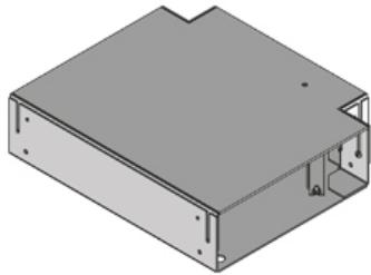
Т-образный отвод для щеточного канала
