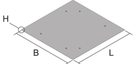
Стальная пластина (дополнительный аксессуар) для временного закрытия монтажного колодца в фальшполу или стяжке, после снятия опалубки. (Диаметр 307 мм и 261x261 мм). С интегрированными болтами с резьбой для предотвращения соскальзывания.
