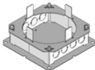
Напольная коробка, из оцинкованной листовой стали. Все стороны могут быть открыты. Включает клемму заземления. Для установки лючка BODO, с предварительной установкой опалубки на период монтажа при необходимости.
