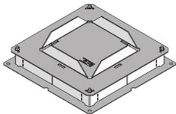
Напольная коробка для пустотных полов из стального листа со сгибающимися боковыми стенками, клеммой заземления и нивелируемым монтажом. Применяется в качестве основания для установки опалубки, которая впоследствии заменяется соответствующим лючком
