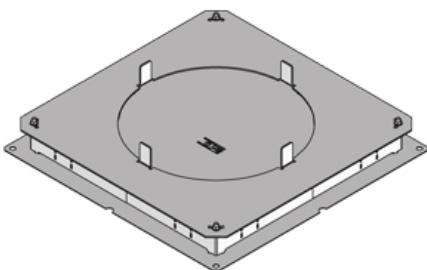
Напольная коробка для пустотных полов, состоит из стальной коробки со сгибающимися со всех сторон боковыми стенками, клеммой заземления и нивелируемого монтажа. Применяется в качестве основания для установки опалубки, которая впоследствии заменяется круглым пластмассовым лючком.
