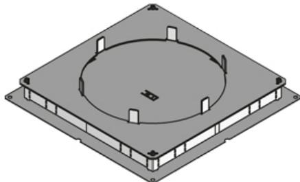
Напольная коробка для пустотных полов, состоит из стальной коробки со сгибающимися со всех сторон боковыми стенками, клеммой заземления и нивелируемого монтажа. Применяется в качестве основания для установки опалубки, которая впоследствии заменяется круглым пластмассовым лючком.
