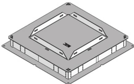
Напольная коробка для пустотных полов, состоит из стальной коробки со сгибающимися со всех сторон боковыми стенками, клеммой заземления и нивелируемого монтажа. Применяется в качестве основания для установки опалубки, которая впоследствии заменяется четырёхугольным пластмассовым лючком.
