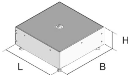
Нивелируемая четырехугольная опалубка, для установки в напольных коробках или монтажных крышках. Состоит из металлической оцинкованной рамы, крышки и нивелирующих ножек. В качестве скрытой опалубки для четырехугольных лючков, устойчивой у механическим воздействиям и жаростойкой. Подходит для укладки в мастику / горячий асфальт или терраццо.
